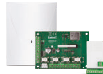
MODULY ROZŠÍRENIA VSTUPOV A VÝSTUPOV
