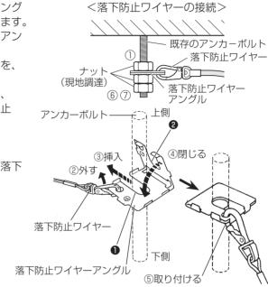
● 既存のアンカーボルトを使用して 落下防止ワイヤーを接続する場合、 中間挿入式ナットを2個使用すると 便利です。
