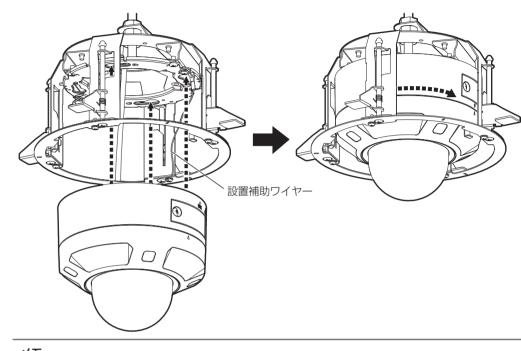
● カメラ本体を持って左に軽く回転させ、カメラのロックプレートが外れないことを確認し てください。
