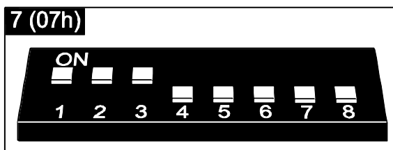
Obr. 13. Spôsob nastavenia adresy na expandéri INT-RX.
